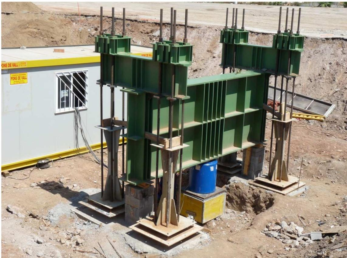
*Figura 14: Prueba de carga de compresión de un pilote*
