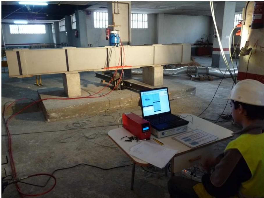
*Figura 10: Prueba de carga de tracción de un micropilote vertical (Tipo 1)*
