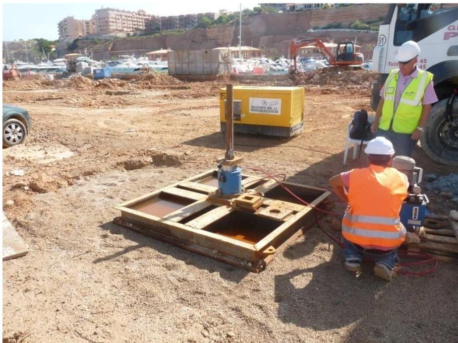
*Figura 11: Prueba de carga de tracción de un micropilote vertical (Tipo 2)*
