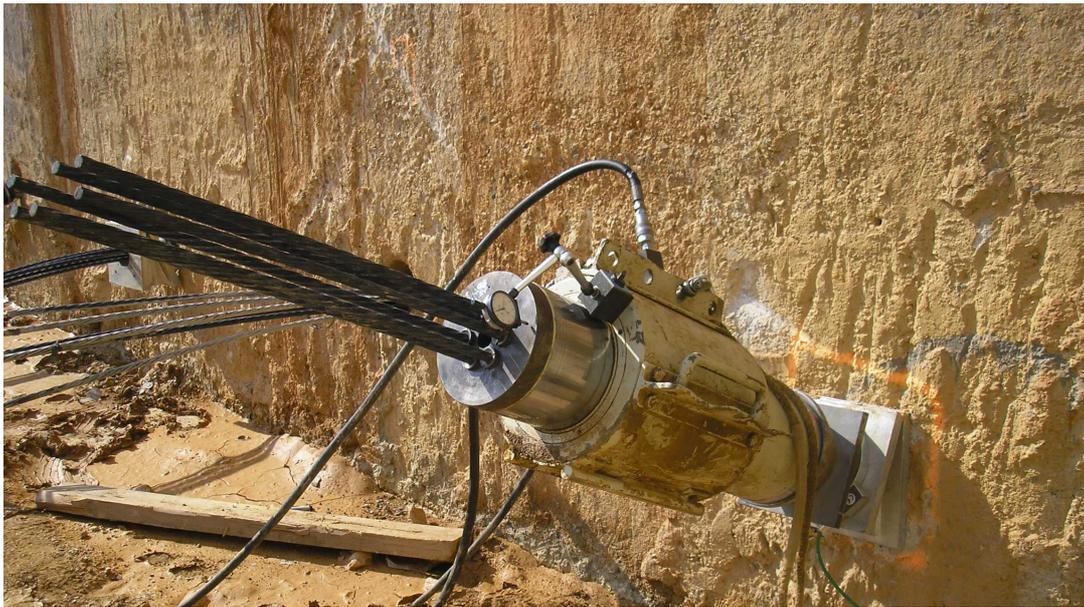
*Figura 6: Ensayo de idoneidad de un anclaje al terreno*
