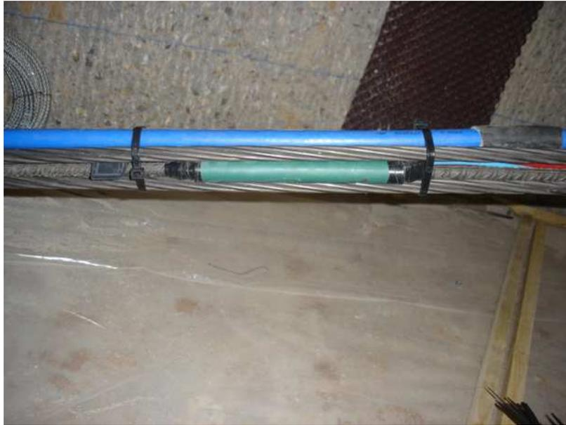
*Figura 16: Montaje de sensores de deformación en el bulbo de un anclaje al terreno*
