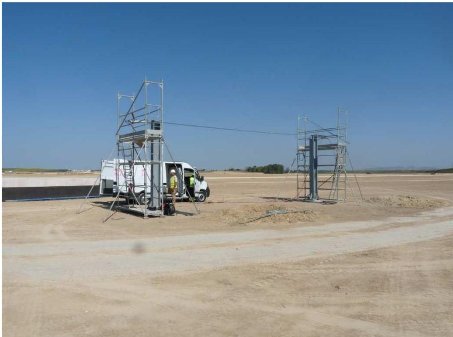
*Figura 13: Prueba carga de micropilotes con empuje lateral y momento*
