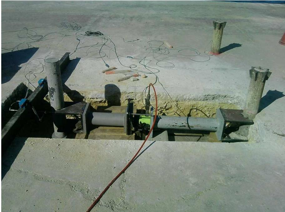
*Figura 12: Prueba de carga lateral de micropilotes*
