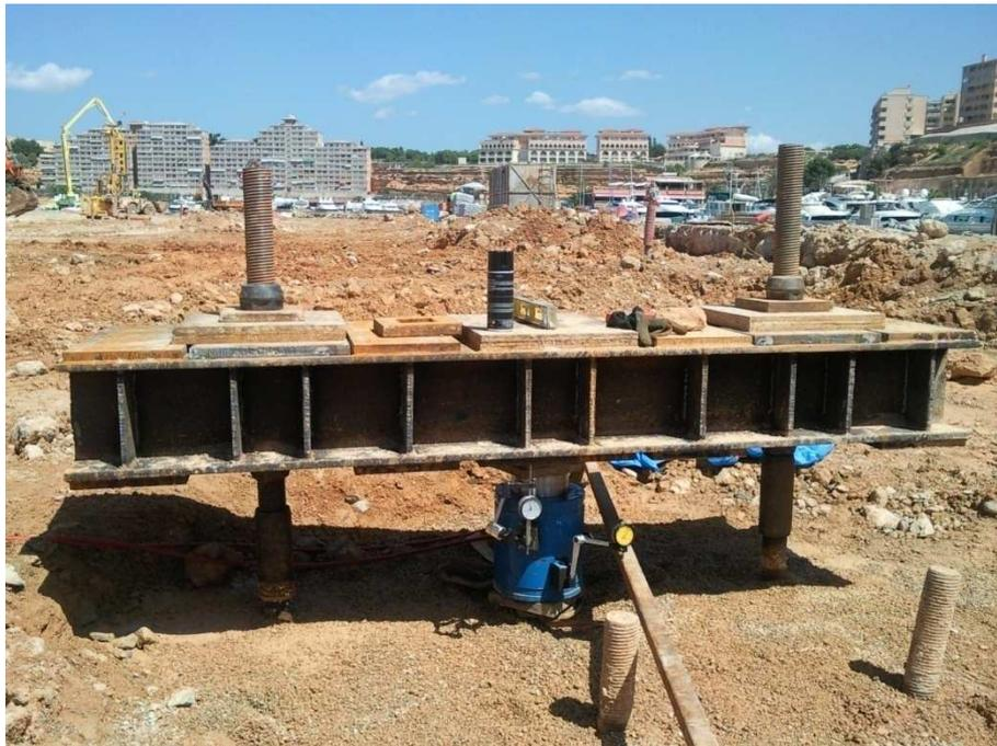
*Figura 8: Prueba de carga de compresión de un micropilote vertical (tipo 2)*
