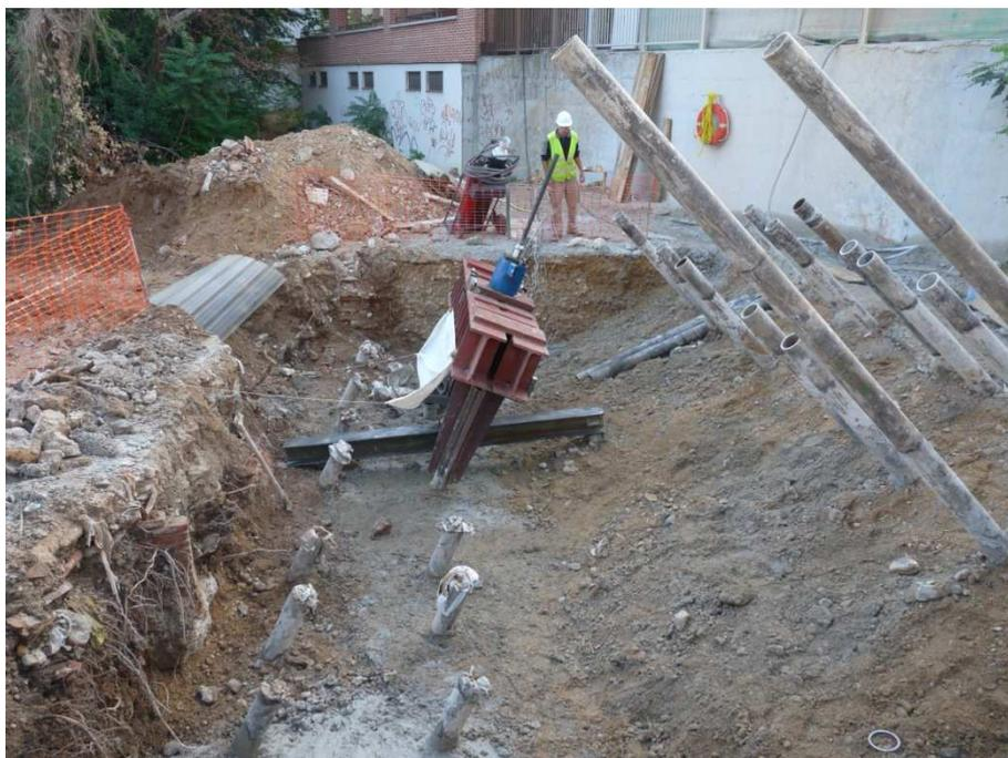
*Figura 9: Prueba de carga de compresión de un micropilote inclinado*
